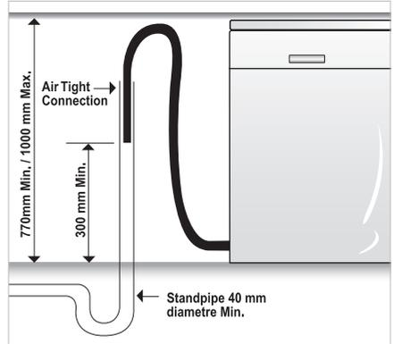
Fig. B : Drainage connection - stand pipe.
